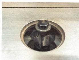
Mit der Ruwischleifmaschine kann ich verschiedene Kanten/Ränder bearbeiten. Z.B. abkanten, abrunden oder Kantenrinne.
