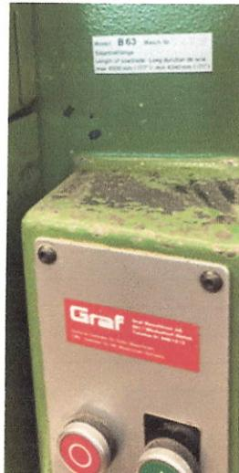
Für ein Bandsägeblattwechsel, kann ich an der Maschine die Breite und Länge ablesen. Wenn nichts steht, gibt es die Faustregel:
