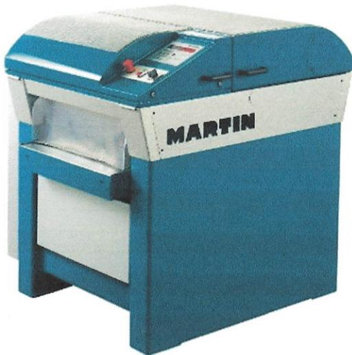
Bei der Dickenhobelmaschine darf man auf keinen Fall in den Kanal greifen auch nicht in die Öffnung blicken. Falls sich ein Werkstück verklemmt, kann ich mit einer schmalen dünnen Holzleiste das Werkstück weiter anschieben. Die Werkstücke lasse ich mehrheitlich rechts und links verteilt durch die Dickenhobelmaschine. Verhindert, dass sich die Walze nicht immer an der gleichen Stelle abnützt. Späne nicht von Hand entfernen.
