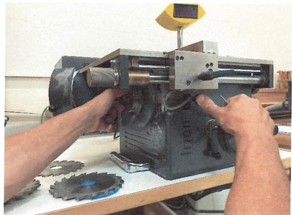
Für den Sägeblatt Wechsel immer Maschine ausstecken. Sägeblatt nach unten stellen, Maschinenachse arretieren und Mutter mit Schlüssel öffnen. Blatt wechseln anziehen und evtl. die Tischeinlage wechseln (schlitz).
