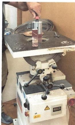
Mit der Zylinderschleifmaschine kann ich Rundungen die nach innen gehen schleifen. Dies nennt man **Konvex**. Rundungen die nach aussen sind **Konkav**, bearbeite ich an der Tellerschleifmaschine.
