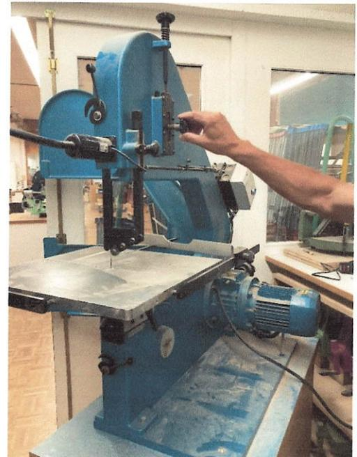
Mit diesem Drehknopf stelle ich die Position vom Sägeblatt ein, damit das Sägeband nicht von der Laufrolle springt. (Justieren)
