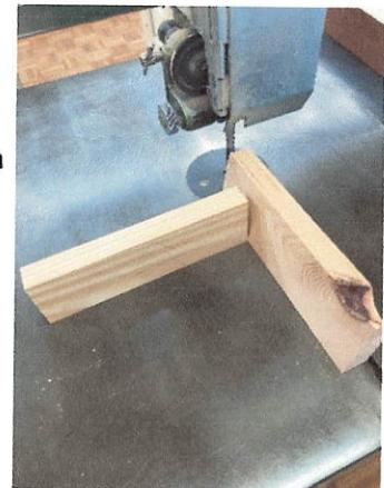
Für gerade Schnitte ist das breite Sägeband geeignet und für Rundungen das schmale Sägeband.
